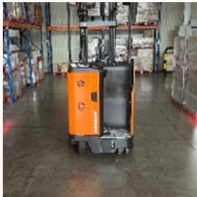
* 지게차 LED빔 설치
